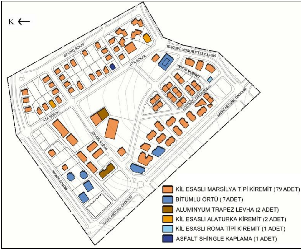
Şekil 5. Safranbolu çalışma alanındaki çatı kaplama malzemeleri. [10].
