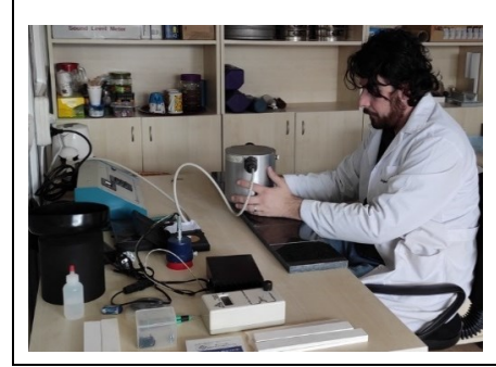
Şekil 5 Numunelerin \beta değerlerinin solar spectrum reflectometer cihazı ile ölçülmesi.
