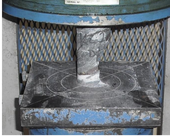
Şekil 3. Tek eksenli basınç dayanımı deneyi sonrasında kayaç malzemesinin görüntüsü
