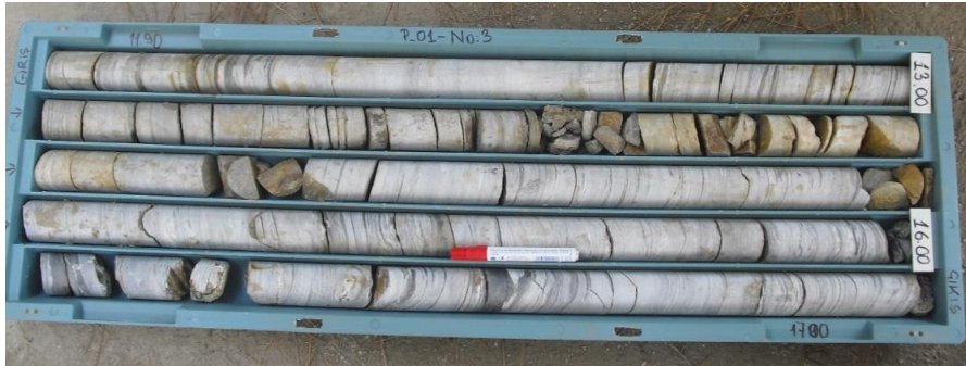
Şekil 2. Cevher ve yan kayaç kesen sondajdan alınan kayaç malzemesi örnekleri
