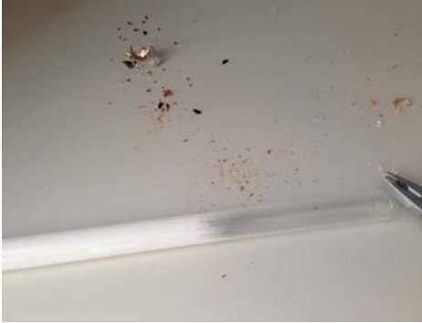
Şekil 6. Lambanın ucundan delik açılması sonrasında fosfor tozunun hareketi
