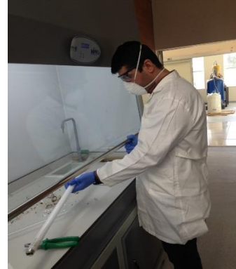
Şekil 5. Parçalama ve ayırma işlemlerinin çeker ocakta yapılması
