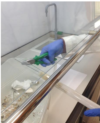
Şekil 7. Fosfor tozunun süpürülerek temiz camın kırılması işlemi
