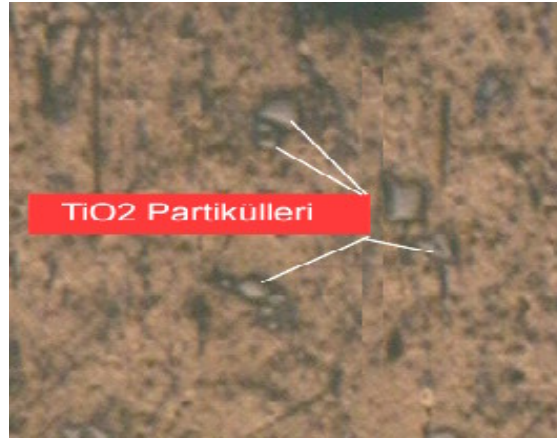
Şekil 9. AlSi12CuNiMg-TiO 2 (% 6) takviyeli malzemeye ait mikroyapısı (x100).
