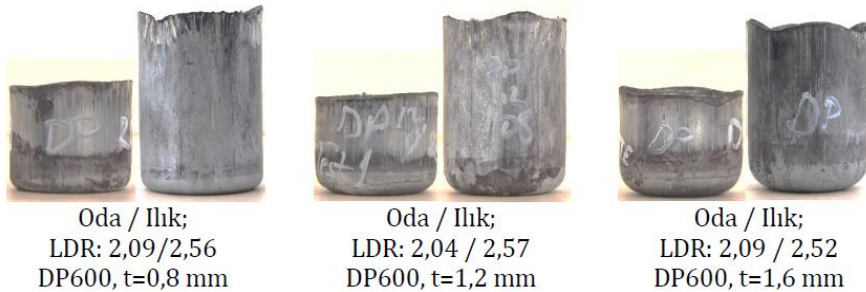
Şekil 11. Oda ve ılık sıcaklıklarda derin çekilen numuneler
