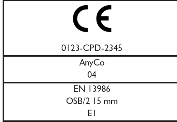
Şekil 4. kuru şartlarda yapısal kullanım için OSB'nin CE işaretlenmesinin gösterimi
