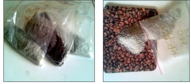
Şekil 2. Granül halindeki nanokompozit numuneleri (a: PET+zeolit, b: rPET+zeolit katkı numuneleri)
