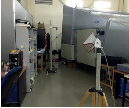
Şekil 10: Ofis ortamında alıcı geniş bant alan probu ile kurulan ölçüm düzeneği
