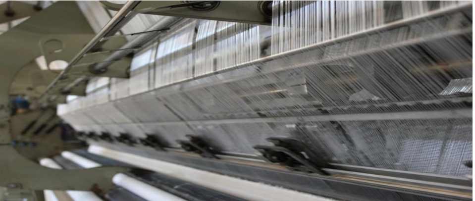
Şekil 2.Ege Balık Ağları Fabrikasında Dynema'nın dokunma anı
