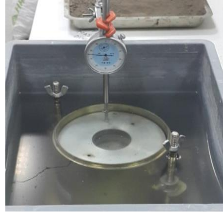
Şekil 3: Küre tabi tutulan CBR numunesi.
