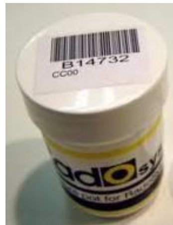
Şekil 3. Plastik difüzyon kabı
