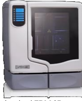
Şekil 11. Topolojik nesne basımında kullanılan ticari FDM 3B yazıcı makinesinin genel bir görünümü (Startasys Model: uPrint SE Plus) [23].
