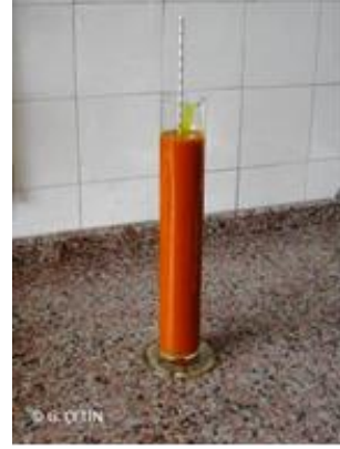
Şekil 2. Kireç-kükürt bulamacı (31–32 baume derecesi) Figure 2. Lime-sulfur mixture (31–32 baume degree)
