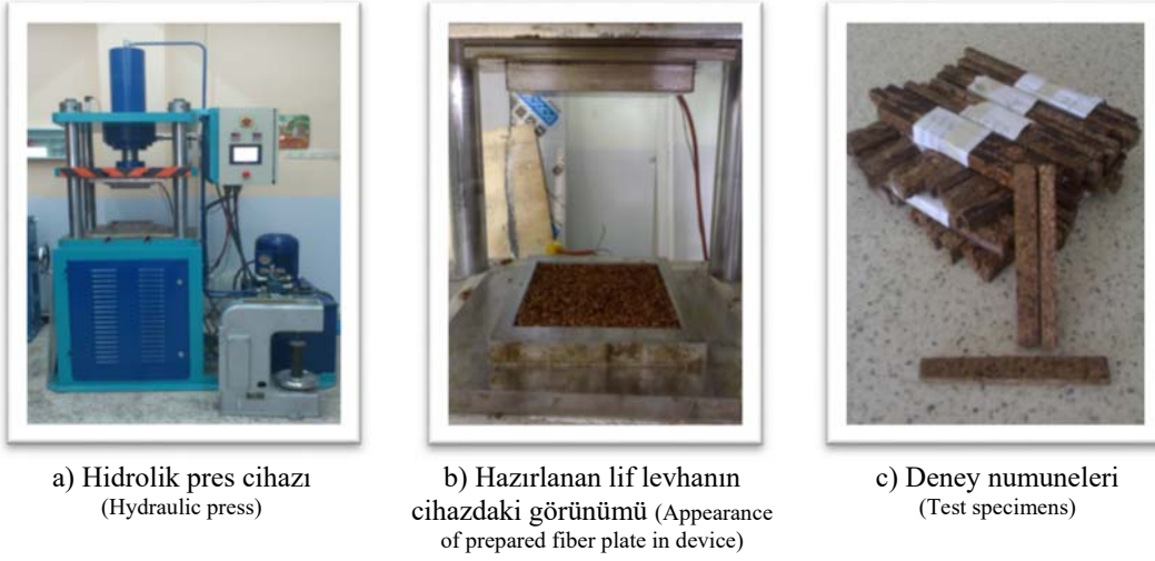
Şekil 3. Hidrolik pres cihazı ve hazırlanan lif levha örneği (Hydraulic press and prepared fiber plate example)
