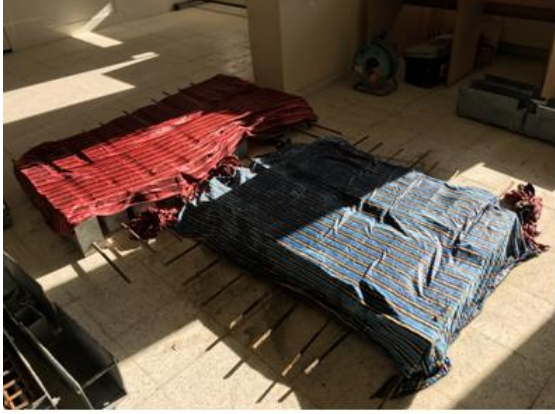
Şekil 5. Mafsallı kiriş deney numunelerine kür uygulaması.
