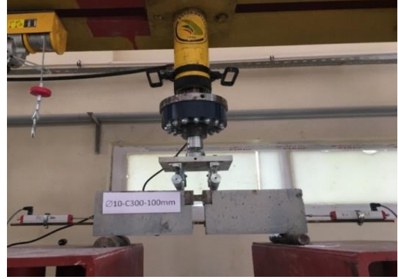
Şekil 6. Mafsallı kiriş deneyinde bir görünüm
