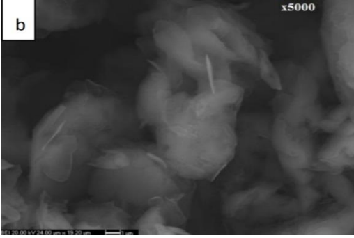
Şekil 3. B_2O_3 ait SEM görüntüleri (a: 1000 büyütme, b: 5000 büyütme) [18].
