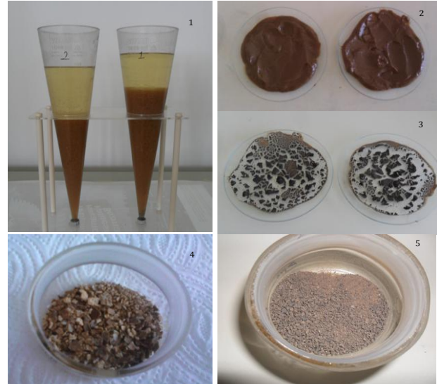
Şekil 3. Biyosorpsiyon çalışmalarında kullanılmak üzere üretilen Ürolitik Mikroorganizma Kültürü (1. İmhoff hunilerine süzülen ÜKMK; 2. Santrifüj sonrası ÜKMK; 3. Etüvde kurutulmuş ÜKMK; 4. Granül; 5. Toz haline getirilmiş ÜKMK)
