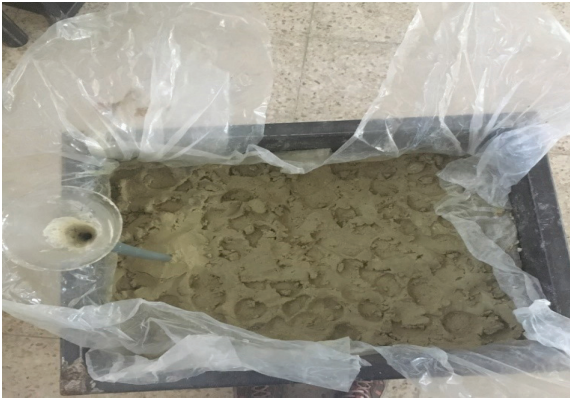
Şekil 8. Modele su girişinin sağlanması.
