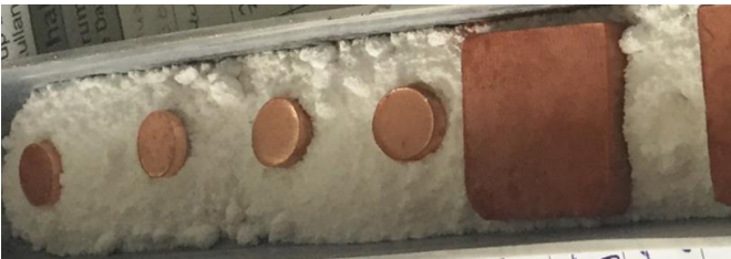
Şekil 10. Alumina altlığa yerleştirilmiş bakır numuneler
