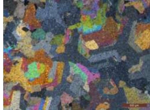
Şekil 3. Tane boyut analizi için hazırlanmış ince kesit görüntüsü, Light Onix
