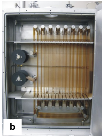
Şekil 17. Lotus rulodan ruloya reaktörü a. şematik gösterimi (Kessels ve Putkonen, 2011), b. fotoğraf görüntüsü (Poodt vd., 2012)
