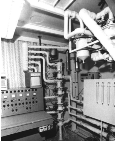
Şekil 5. Pilot ölçekli yüksek hassasiyetli gaz faz nem indikatörü üretimi için kullanılan ML reaktörü (Malygin vd., 2015)
