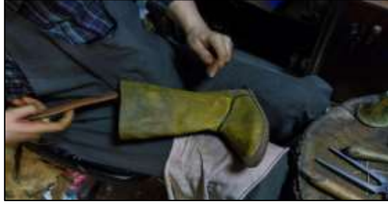
Resim 40: Levger yardımıyla ediğin dış yüzeyinin düzleştirilerek şekillendirilmesi.
