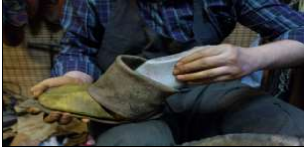
Resim 36: Düz tarafı çevrilen ediğin içine kalıbın oturtulması.
