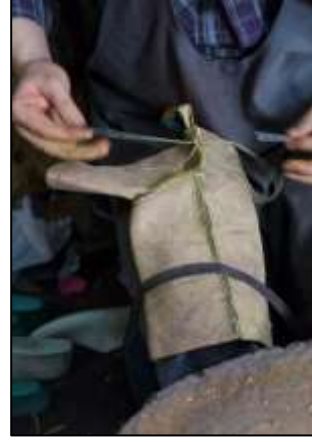
Resim 26: Birleştirilmesi işlemi esnasında, parçalar arasında renk tercihine göre ince biye dikiş yapılır.
