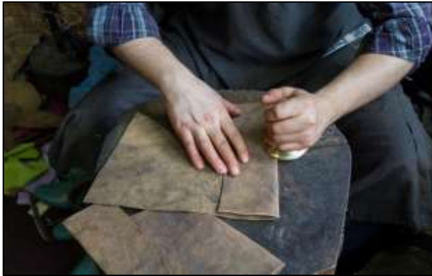
Resim 13: Ön ve arka ortaları bulunan konç derisi muşta yardımıyla ezilerek orta çizgileri sabitlenir. Bu işlem dikiş işleminin kaymaması için bir ölçü kılavuzu olarak kullanılır.
