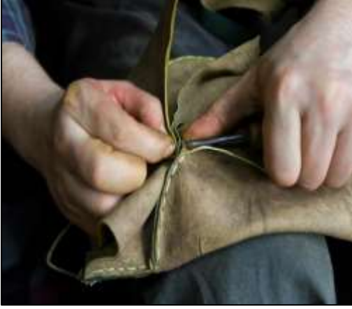
Resim 26: Birleştirilmesi işlemi esnasında, parçalar arasında renk tercihine göre ince biye dikiş yapılır.
