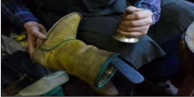
Resim 46: Edik'in kenar süsü dikilen kıyasına dövüştürme yaparak düzeltilmesi işlemi.
