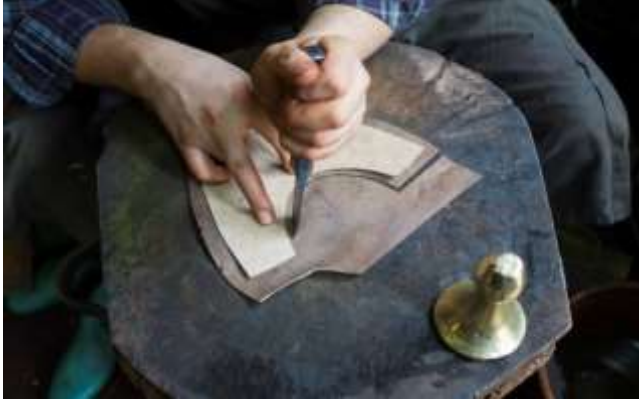
Resim 11: Edik'in burun kısmını oluşturan yüzün, deri üzerine endeze koyularak kesim işlemi.
