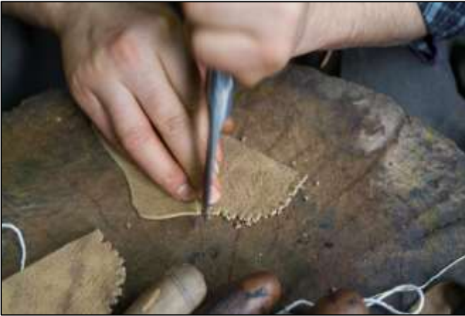
Resim 24: Kesilen tozluğun bıçak yardımıyla çapraz kesikler atarak, kenar süsünün yapım işlemi.
