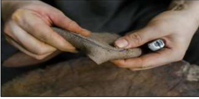
Resim 28: Taban derisi yarıldıktan sonra dikiş kanalının görüntüsü
