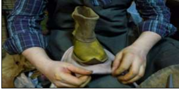
Resim 37: İç kalıbı oturtulan ediğin pamuk beze sarılarak muşta ile dövüştürülmesi.
