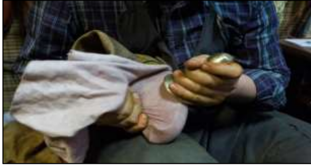
Resim 38: İç kalıbı oturtulan ediğin tabanına şekil verilmesi.
