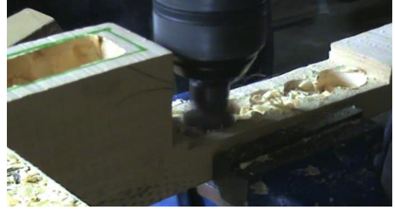
Resim 8. Matkap yardımıyla analık yatağının açılması
