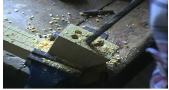
Resim 6. Kepçe Bölümünün Matkap Yardımıyla Oyulması
