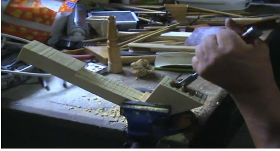
Resim 7. Iskarpela yardımıyla kepçenin iç kısmının genişletilmesi
