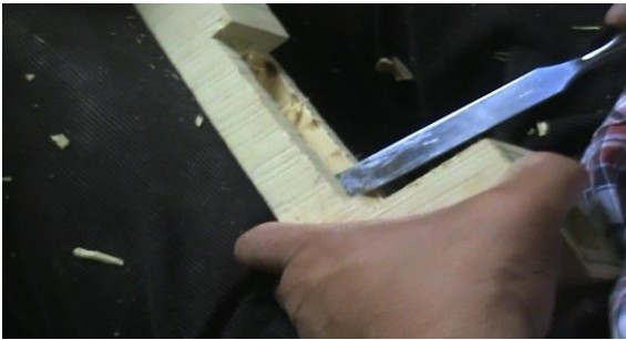
Resim 9. Iskarpela Yardımıyla Analık Yatağının Düzeltilmesi ve Genişletilmesi
