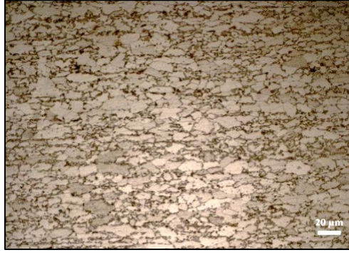
Şekil 1. DP600 çeliğinin mikroyapı görüntüsü Tablo 1. DP600 çeliğinin kimyasal bileşimi (%)
