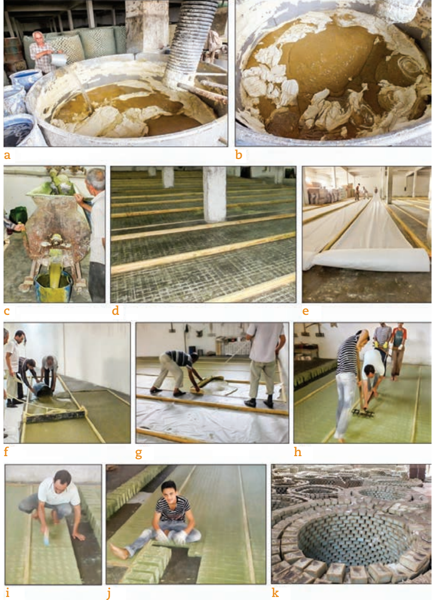
Şekil 1. Nizip'te sabun yapım aşamaları: a. Kaynamış sabun hamuruna tuzlu su karıştırılması.;b. Dinlendirilerek hazır hale getirilmiş sabun hamuru; c. Sabun hamurunun kovalara aktarılması. d. Taraklama rayları; e. Taraklama raylarına pelür kağıdının serilmesi; f. Sabun hamurunun taraklama raylarına serilmesi; g. Taraklama raylarında sıyrığı ile raspalama yapılması; h. Sabun hamurunun kesilmesi; i. Kesilmiş sabun hamurlarının damgalanması; j. Damgalanmış sabun kalıplarının toplanması; k. Sabun kafesinin hazırlanması.
