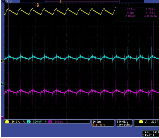
Şekil 18: Dönüştürücülerin yük akımını paylaşımı. (yukarıdan aşağıya) a) Toplam çıkış akımı (200A), b) birinci koldaki endüktans akımı, c) ikinci koldaki endüktans akımı
