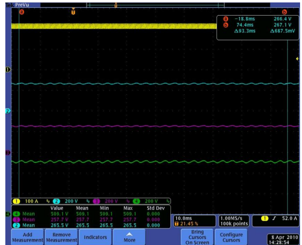
Şekil 17: Dönüştürücülerin bara gerilimini paylaşımı. (yukarıdan aşağıya) a) DA bara gerilimi, b) birinci seri kol gerilimi, c) ikinci seri kol gerilimi, d) yük akımı.
