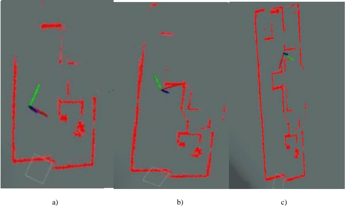
Şekil 6. Otonom olarak hareket eden Turtlebot'un SLAM uygulaması a)1. adım, b) 2. adım ve c) 3. adım
