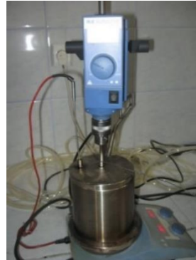
Şekil 1. Modifiye bitüm karıştırıcısı
