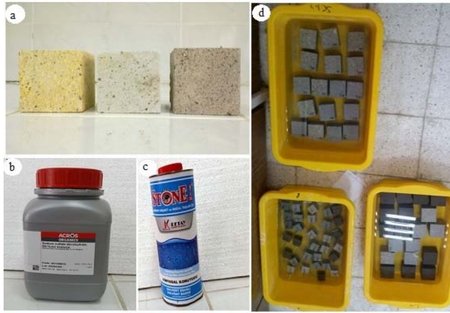
Şekil 2. Deneylerde kullanılan materyaller: yapı taşı örnekleri tüf ve andezit a) sodyum sülfat b) su itici kimyasal c) ve tuz kristalleştirme deneyi çözelti tankları
