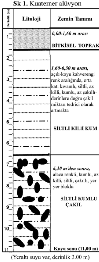
Şekil 5. Kuaterner alüvyon ve akarsu taraçası (Ürgerpaşa mahallesi) ile Üst Pliosen kiltasında (Emek mahallesi) açılan sondaj kuyularına ait jeolojik kesitler.
