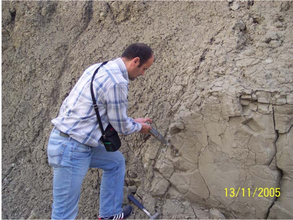
Foto 2. Üst Pliosen kiltası ve Schmidt çekici geri tepme sayısının ölçümü.
