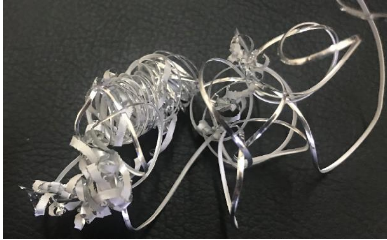
Şekil 4. İşleme testi sonucunda alınan talaşın görüntüsü (Figure 4. Effects of processing parameters on surface roughness)
