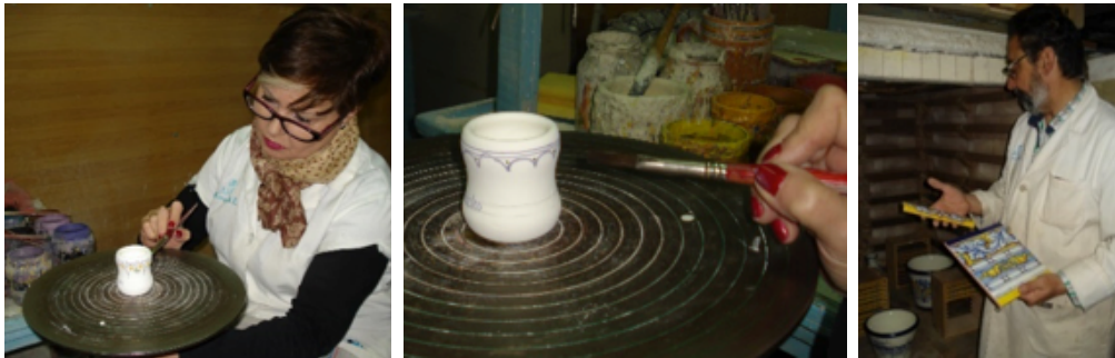
Görsel 12. Fırça ile mayolika dekorlarının yapılması
