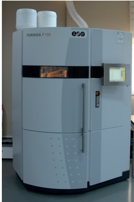
Resim 6. İki Parçalı Şahi topu modelinin üretildiği EOS P110 modeli SLS eklemeli üretim cihazı.
