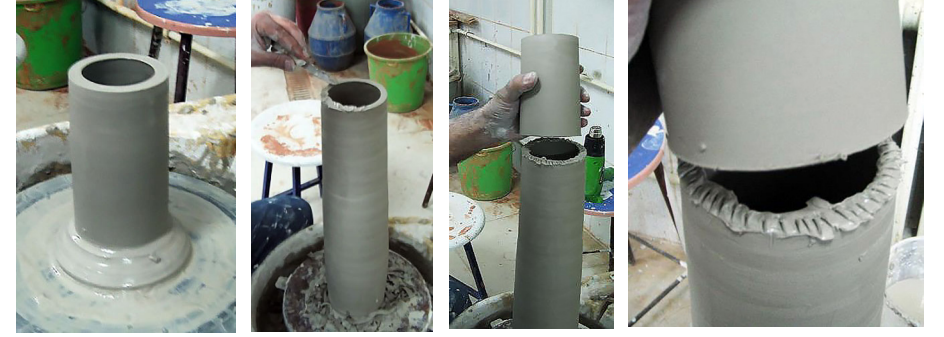
Görüntü 15. Dördüncü parçanın çekilmesi ve birleştirme işlemi.
