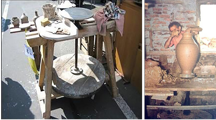
Görüntü 2. Geleneksel ayaklı çömlekçi çarkı 6 ve Geleneksel çömlekçi çarkında çalışan bir çömlekçi ustası. 7
