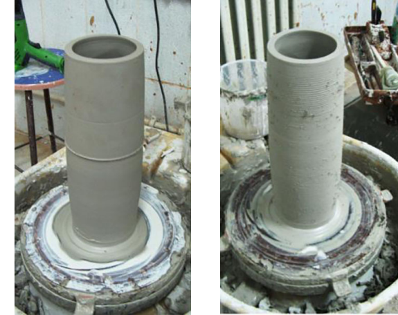
Görüntü 13. İlk iki parçanın eklenmiş ve testere ile düzeltilerek gönyeye alınmış hali.
