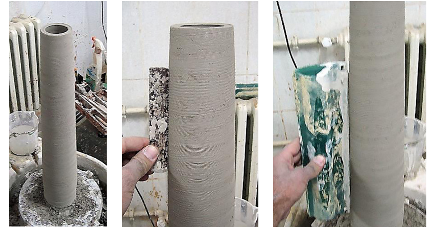
Görüntü 16. Dördüncü parçanın eklenmesinin ardından formun dış hatlarının gönyeye getirilmesi işlemi.
