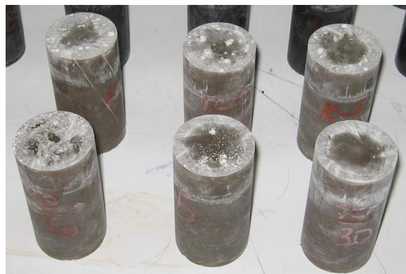
Şekil 2. Basma deneyi öncesi kuvars takviyeli kompozit numuneler (The quartz reinforced composite samples before the compression test)
