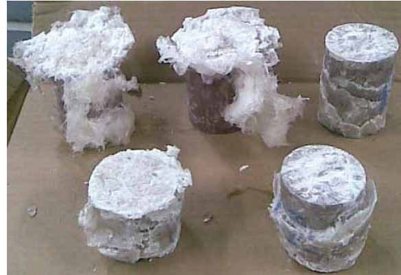
Şekil 3. Basma deneyi sonrası elyaf takviyeli kompozit numuneler (The fiber reinforced composite samples after the compression test)
