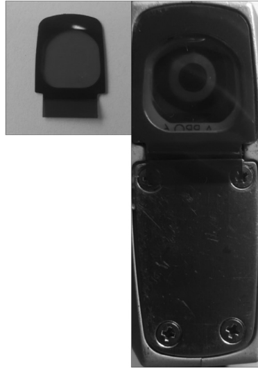
Fig. 4 P-EDXRF'te toprak kirliliğinin eser analizindeki etkisini azaltmak için kullanılan filtre
