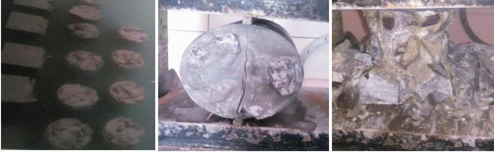
Şekil 4. Kaya dolgu beton numunelerin kürü ve testleri
