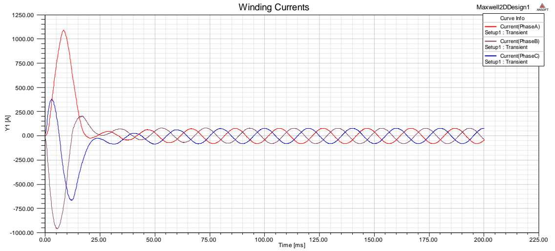
Şekil 2.3. Asenkron motorun Akım-Zaman stator çıkış sinyali
