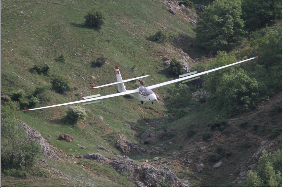
Resim 5. THK İnönü Havacılık Merkezinde Spoiler Açık Şekilde Son Yaklaşma Dönüşü Yapan Bir SZD-50-3 PUCHACZ Çift Kişilik Eğitim Planörü (Yazar Göksele KESKİN' in arşivinden).
