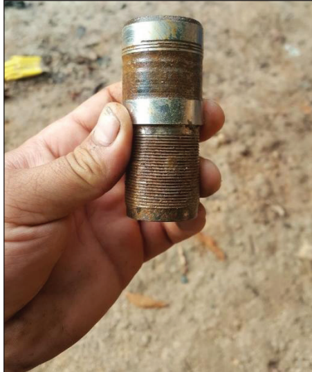
Şekil 5. Servis Ömrünü Tamamlamış Sert Krom Kaplanmış Araparça
