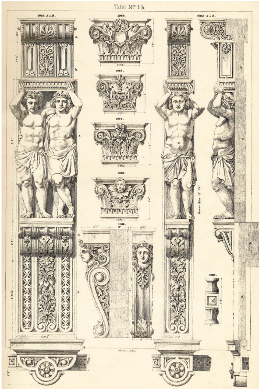
Sekil 9. Viyana merkezli Heinrich Drasche Firmasına ait alçı ve çimento öndöküm mimari bezeme elemanı kataloğundan örnek bir sayfa ve yukarıdaki bezeme detaylarına benzeyen elemanlardan detay (kaynak Prof. J. Weber). Öndöküm bezeme elemanlarının tasarımındaki düzen ve detayların karmaşıklığı dikkat çekici düzeydedir.
