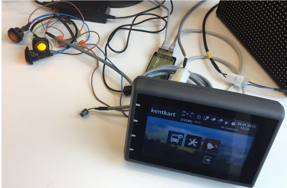
Şekil 9. VEHICLEtoIP servisi uygulaması için oluşturulan kapı durumu test ortamı.
