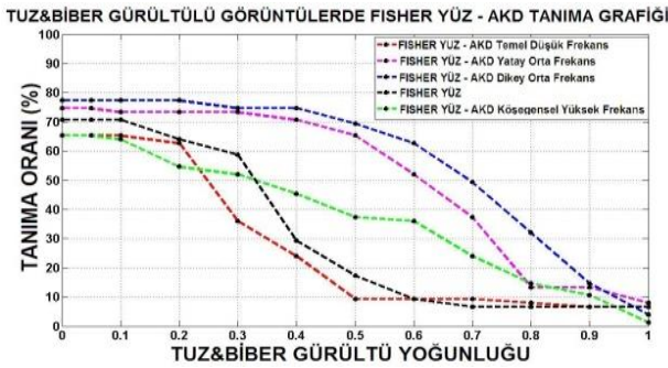
Şekil 12: AKD bileşenleri ve orijinal görüntü ile tuz&biber gürültülü yüz uzayında yer almayan görüntülerde Fisher Yüz tanıma başarımları grafiği
