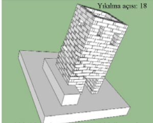
Açıklık 15: Asimetrik köşeye bitişik orta boyutlu ve asimetrik küçük boyutlu üst, asimetrik köşeye bitişik alt açıklık
