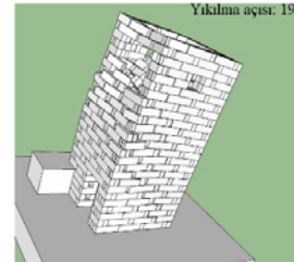
Şekil 7. Duvar profili 6'nın farklı açıklık düzenlerinde duvar davranışları (Wall behavior of wall profile 6 in different opening arrangements)
