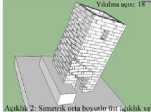
Açıklık 2: Simetrik orta boyutlu üst açıklık ve alt açıklık
