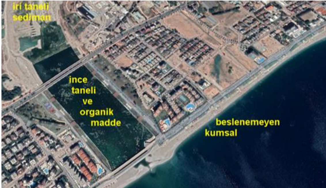
Şekil 1. Değişen sediman rejimi sonrasında Boğaçay ve Konyaaltı sahilinin durumu
