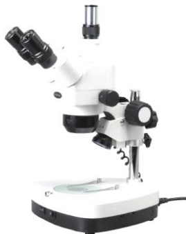
Şekil 2. Boyutsal doğruluk için kullanılan mikroskop
