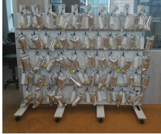
Şekil 1. Çalışmada kullanılan örnek reaktör şeması ve 50 reaktörden oluşan düzeneğe ait fotoğrafik gösterim.
