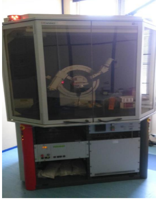
Şekil 2. Numunelerin kırınım deseninin alındığı Bruker AxsDS Advance model difraktometre
