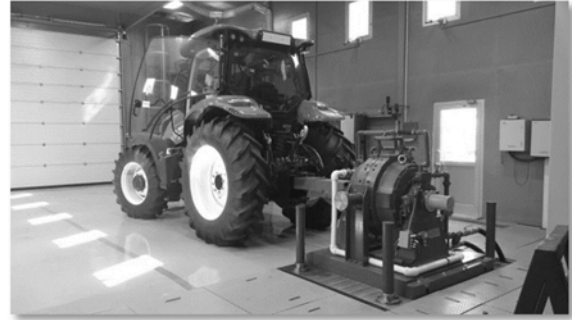
Şekil 2. OECD Kod 2'ye göre Traktör Performansı Test Düzeni
